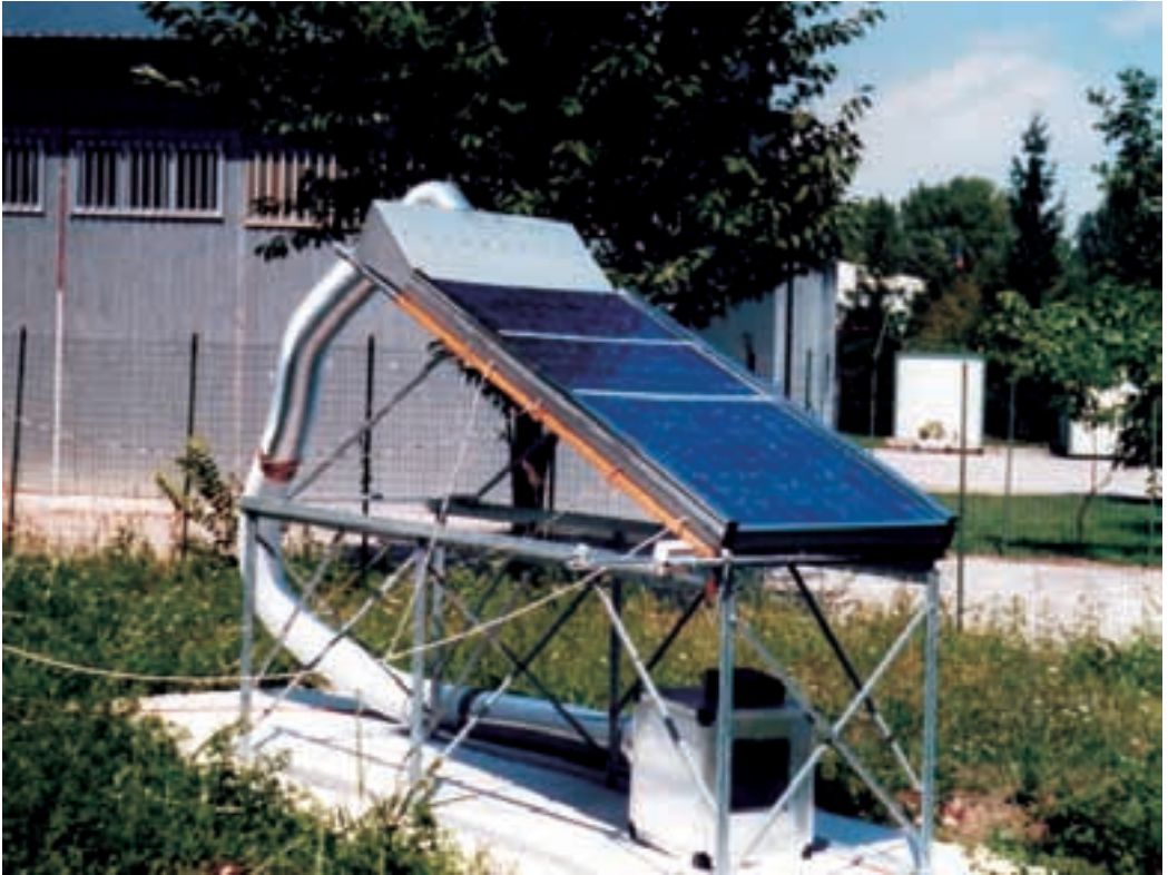
Figura 2.11 Sistema ibrido fotovoltaico termico, prototipo sperimentale (fonte: Secco Sistemi).
